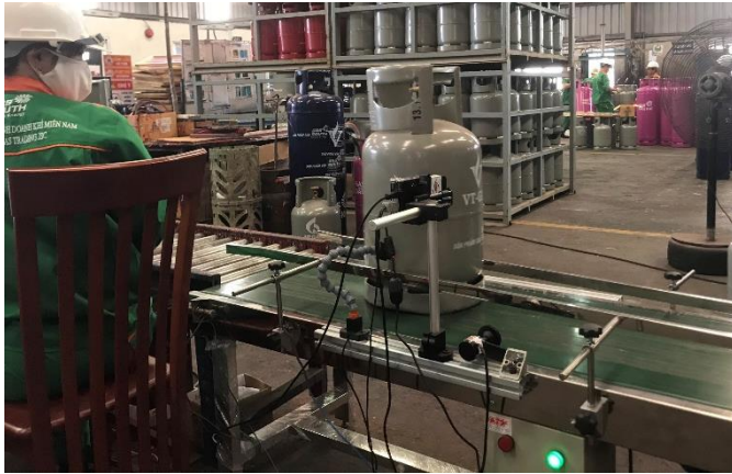
Hệ thống in tự động tại nhà máy sản xuất, sửa chữa vỏ Bình
